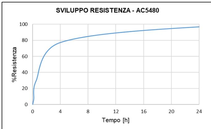
**Caratteristiche tipiche dell'adesivo polimerizzato 72h a +25°C**
